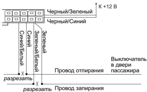
Схема 4. Вакуумная система центрального замка (Mercedes-Benz и Audi)
